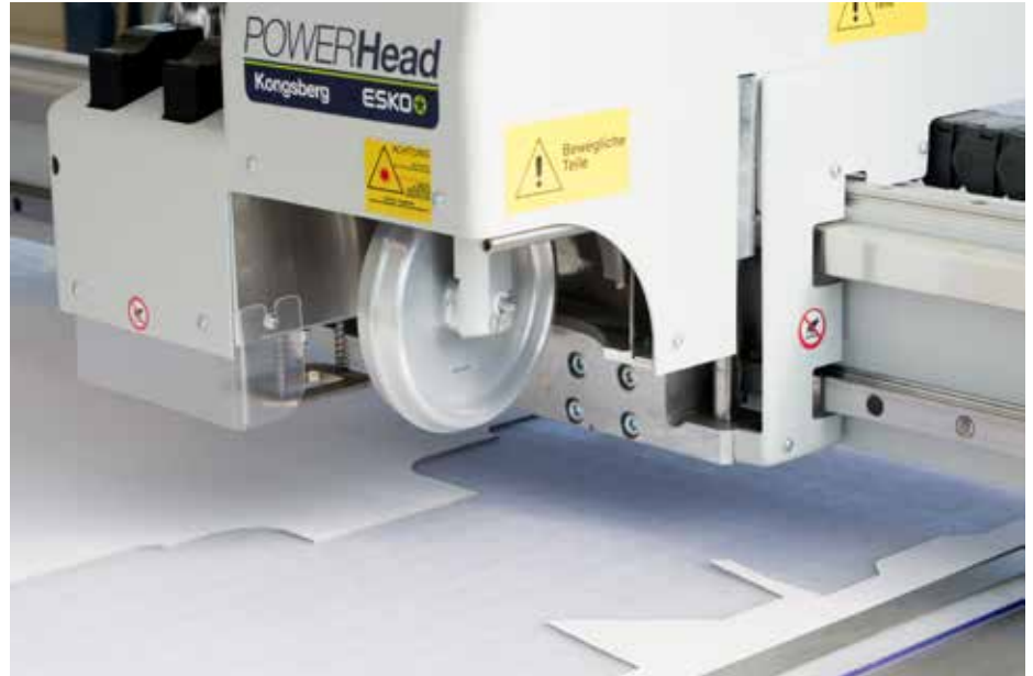
Brandneuer Plotter zur Herstellung von Verpackungsmustern
